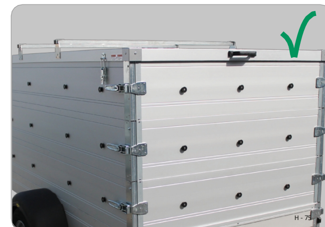
Aluminiumsdeksel lukket/låst (kjørestilling)
