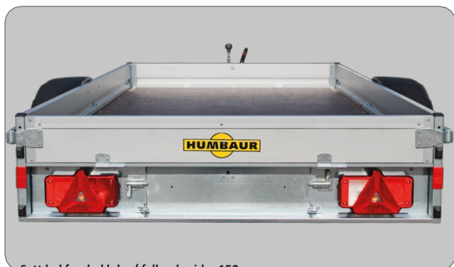
Sett bakfra: bakluke / fallende sider 150 mm
