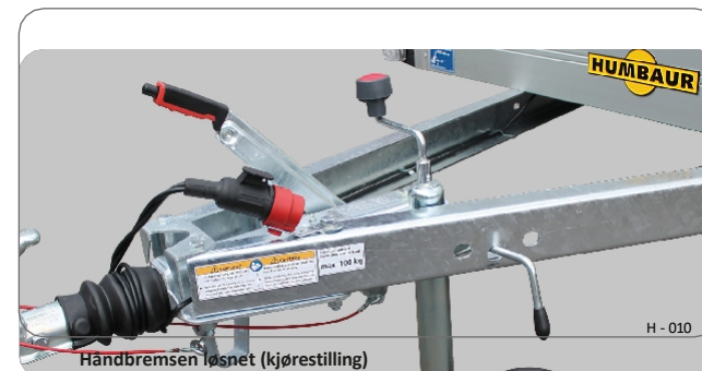
Håndbremsen løsnet (kjørestilling)
