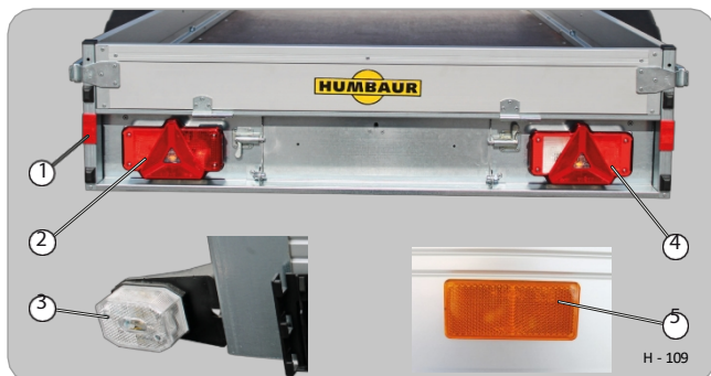
Belysningsarmaturer/markeringer på tilhengeren
