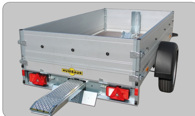
Opcja: Wahacz motocyklowy, szyny wjazdowe, mocowanie BW 1x
