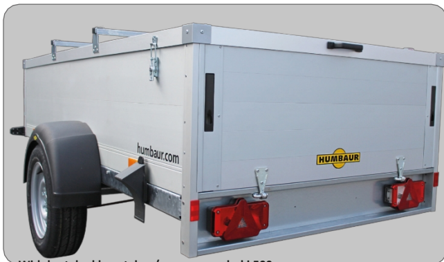
Widok z tyłu: klapa tylna / opuszczane boki 500 mm
