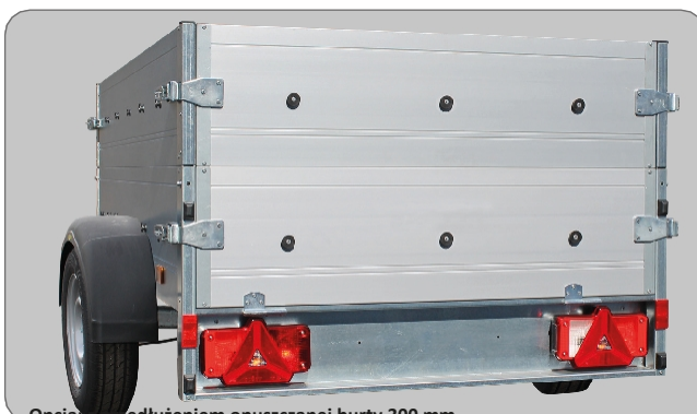
Opcja: z przedłużeniem opuszczanej burty 300 mm
