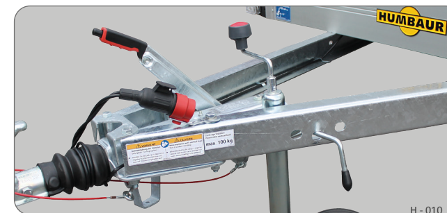
Frein à main desserré (en position de conduite)
