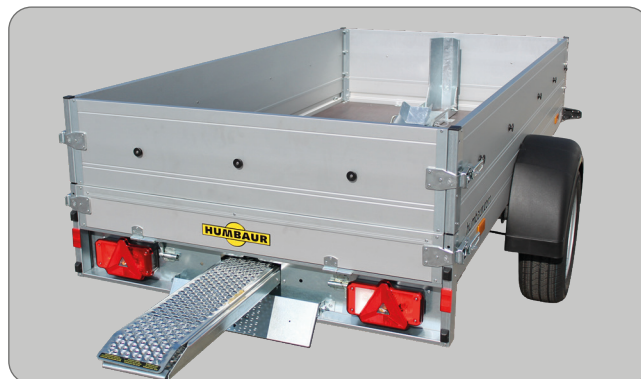
Option : bloque-roue de moto, rail de chargement, 1 rangée de rehausses de ridelles
