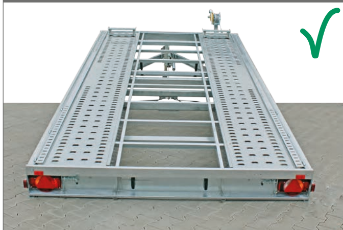
Le dispositif anti-encastrement repose entièrement sur le sol
