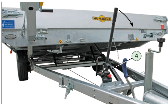
Basculement hydraulique de la surface de chargement
