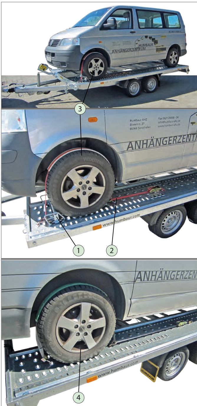
Châssis MTK - Arrimage de la cargaison
