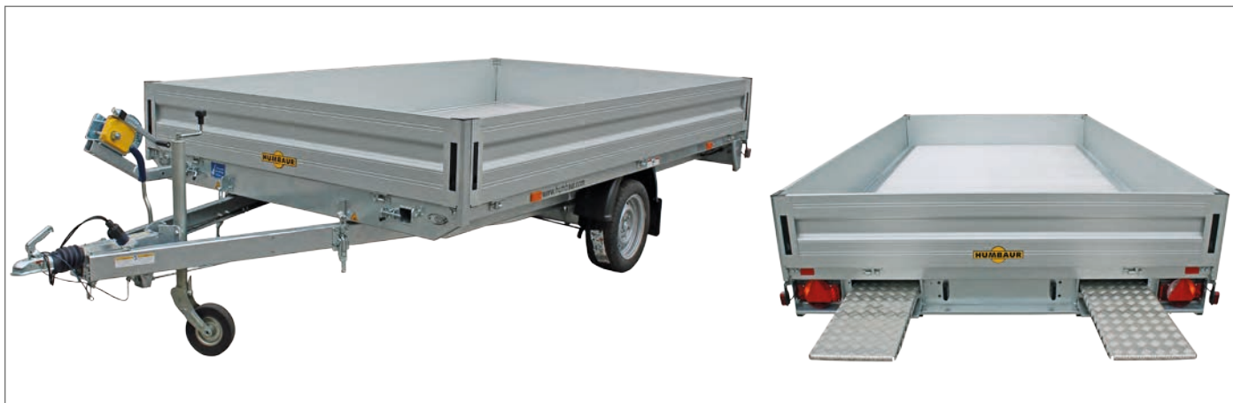
MTK à un essieu avec ridelles de 350 mm et rail de chargement
