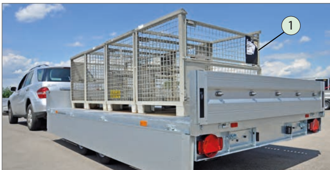
Voorbeeld "vormgesloten ladingbeveiliging"
