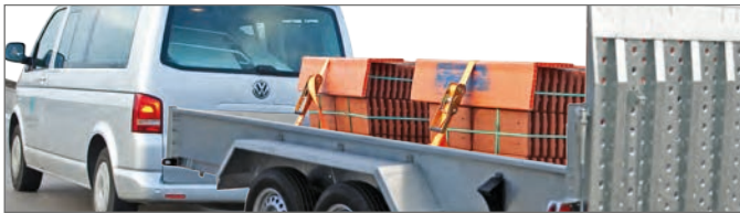
Voorbeeld "krachtgesloten ladingbeveiliging"
