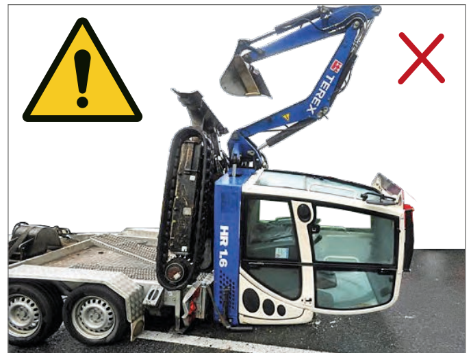
Ongeval voorbeeld (minigraafmachine was niet vastgesjord)
