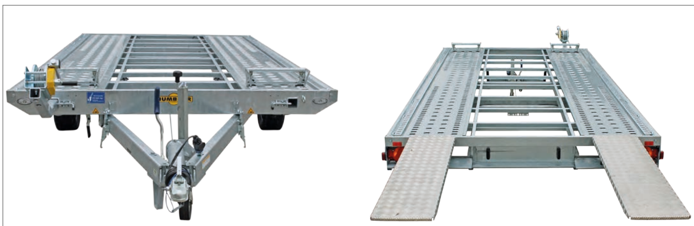
MTK tandem onderstel met verticale rails (zonder boordwanden)
