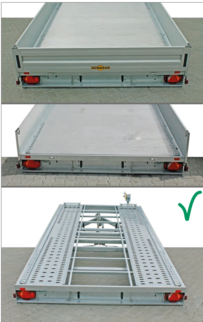
Onderrijbeveiliging ligt volledig op de ondergrond
