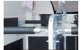
inklusive (Serienausstattung) Höhenverstellbare und arretierbare EquiLock® Trennwand
