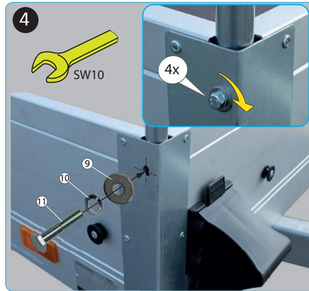
► Eckpfosten mit Schraubverbindung sichern.
