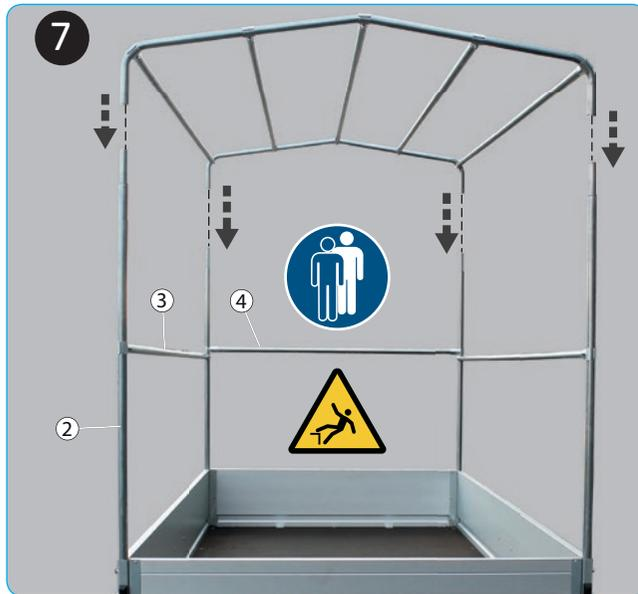
► Vormontiertes Dachspriegel auf die Pfosten aufstecken.
