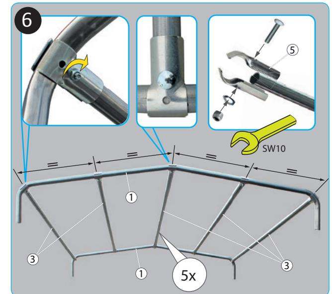
► Längsträger (Pos.3) mit Dachträger (Pos.1) verbinden.
