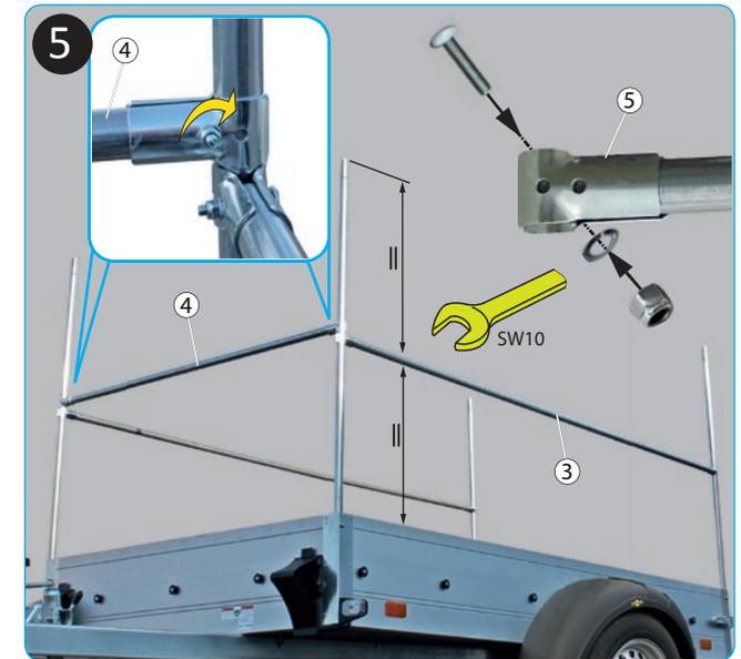
► Längsträger (Pos.3) + Querstange (Pos.4) montieren.
