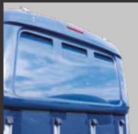
GVK-windklep met geïntegreerd derde remlicht (optioneel) voor Balios®, Xanthos®, Zephir® en Maximus®
