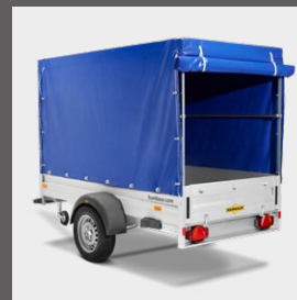
Bâche et arceaux, hauteur de chargement de 1 000 / 1 300 / 1 600 / 1 800 mm ( finition selon le modèle)
