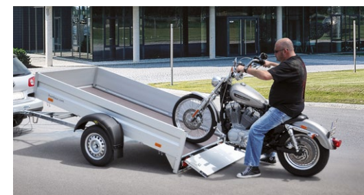
Rampe sur la HA basculante
