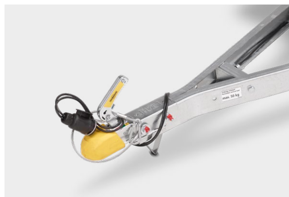
Timon de traction en V galvanisé à chaud avec traverse
