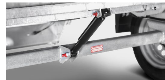
Caisse basculante (basculante sur HA) avec support amortisseur
