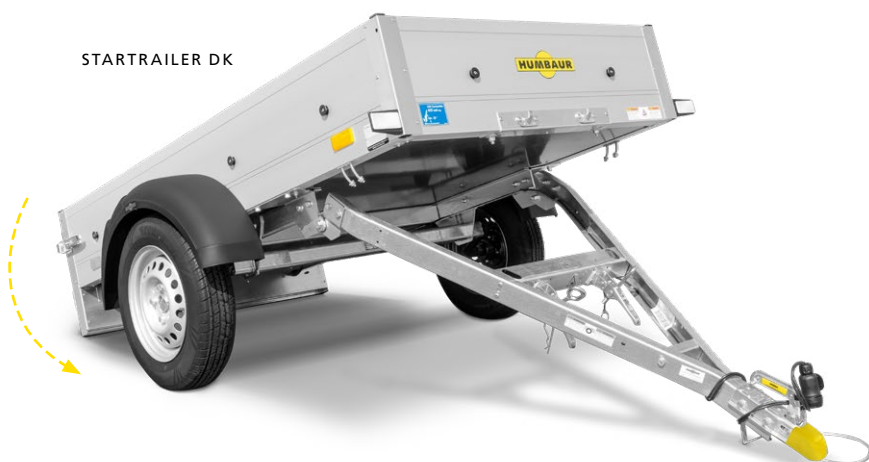
Timon de traction en V galvanisé à chaud
