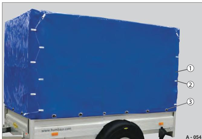
Fig. 61 Fissaggio con fune elastica / graffe
