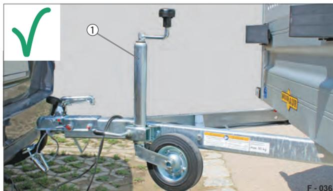
Fig. 6 Ruotino d'appoggio (in posizione di marcia) giusto
