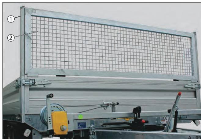
Fig. 29 Rialzo in griglia d'acciaio
