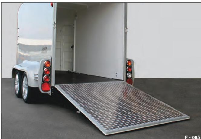
**Fig. 68** Esempio 2: Sponda di carico
