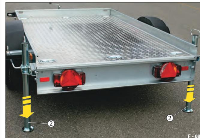
Fig. 21 Sostegno per le operazioni di scarico
