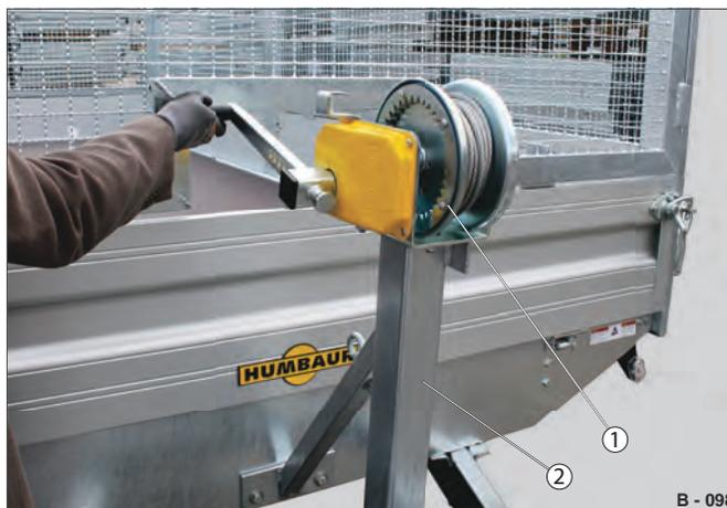
Fig. 39 Variante 2: verricello centrale fisso
