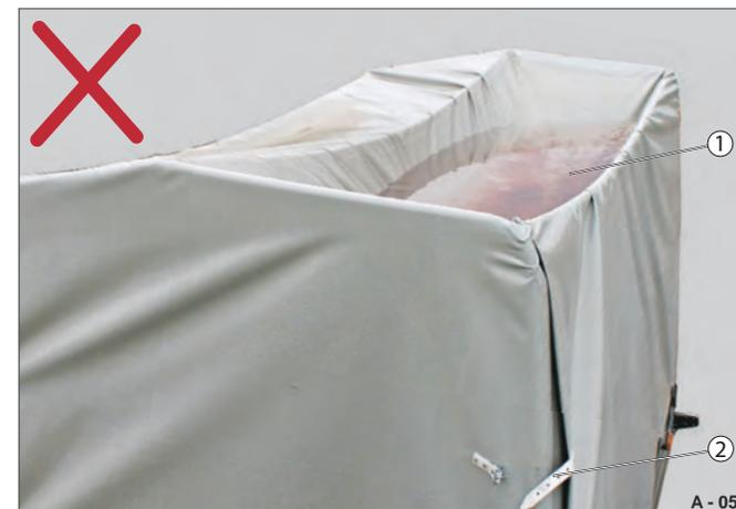
Fig. 66 Esempio: Carico d'acqua su telone alto
