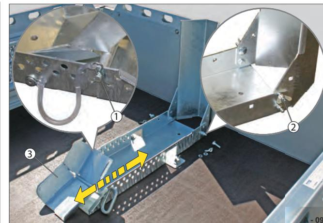
Fig. 100 Cavalletto per motocicli aperto / fissato
