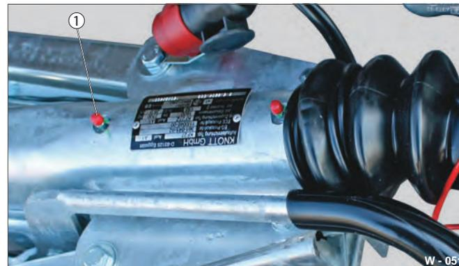
**Fig. 40** Preparazione dei raccordi di lubrificazione
