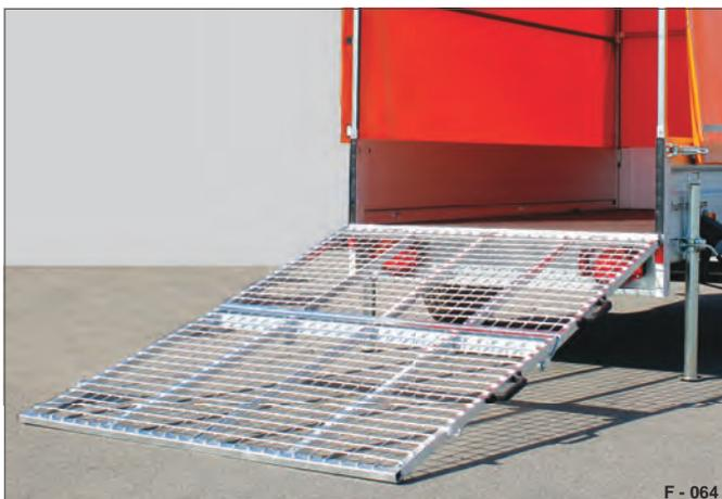
**Fig. 67** Esempio 1: Sponda di carico in griglia d'acciaio
