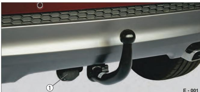
**Fig. 1** Collegamento elettrico al veicolo trainante (automobile)
