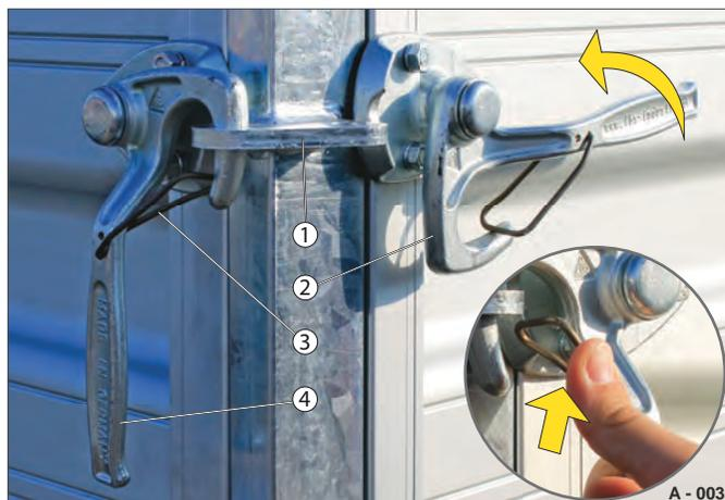
**Fig. 8** Chiusura a leva angolare (HTK, HT, furgonato, cavalli)
