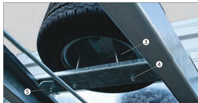
Fig. 18 Fissaggio della ruota di scorta
