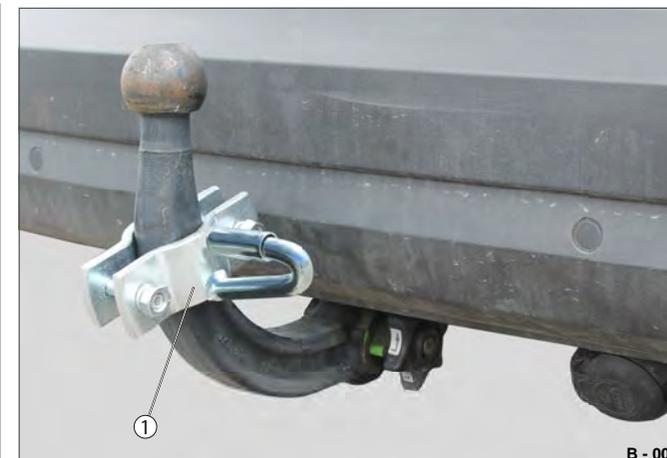
**Fig. 6** Esempio: Dispositivo di fissaggio nel gancio
