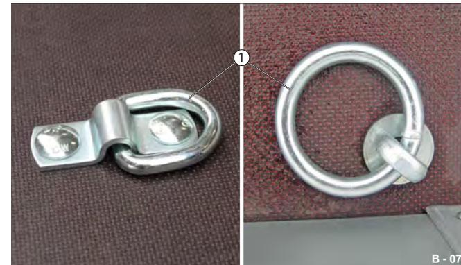
Fig. 59 Punti di ancoraggio appoggiati (opzionali)
