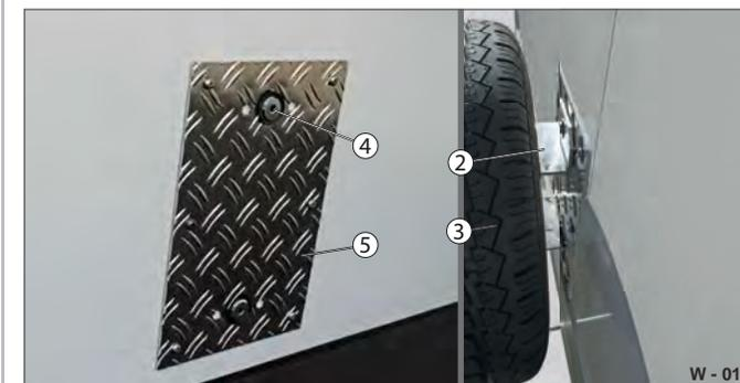
Fig. 20 Fissaggio della ruota di scorta
