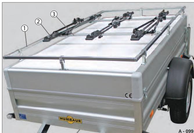
Fig. 95 Portabici montato
