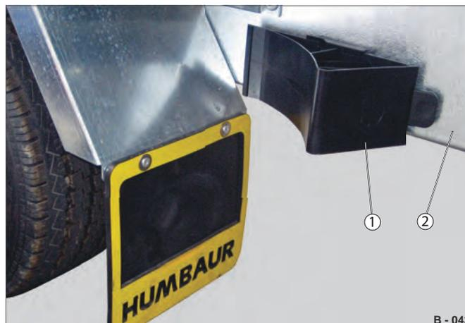
Fig. 77 Esempio 2: Cunei orizzontali laterali
