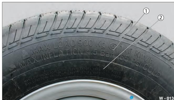
Fig. 15 Pressione di gonfiaggio pneumatici - Dati
