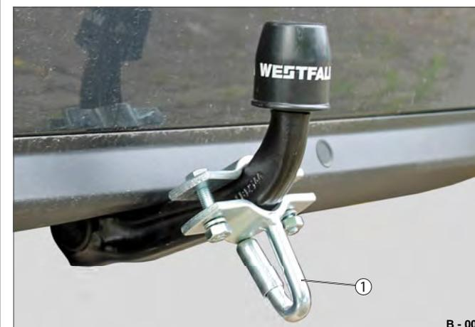
**Fig. 7** Esempio: Dispositivo di fissaggio nel gancio
