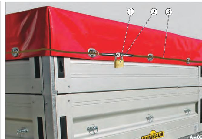
Fig. 60 Cavo di sicurezza conforme ai requisiti doganali per la protezione dai furti
