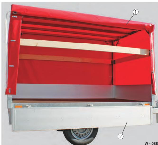
**Fig. 84** Ventilazione / asciugatura del rimorchio
