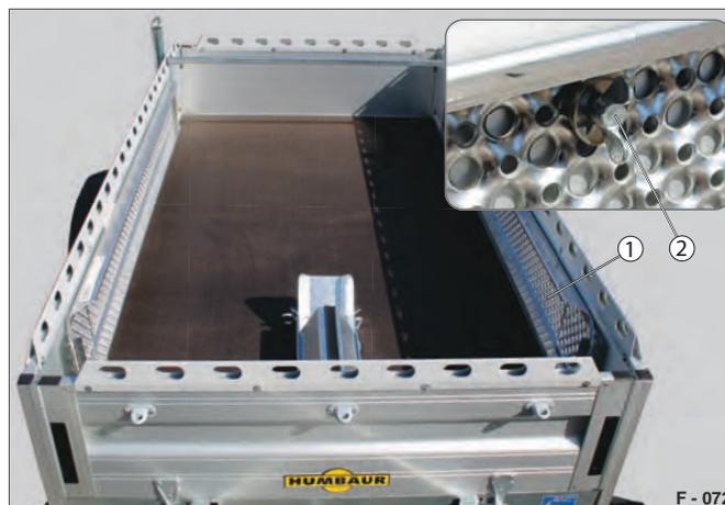
**Fig. 75** Esempio: allrounder HA, rampe di carico fissate
