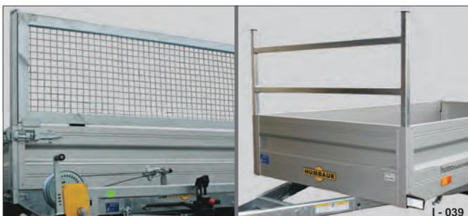
Fig. 49 Sponda in griglia d'acciaio / telaio a H
