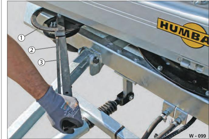
Fig. 57 Punto di lubrificazione freno corona
