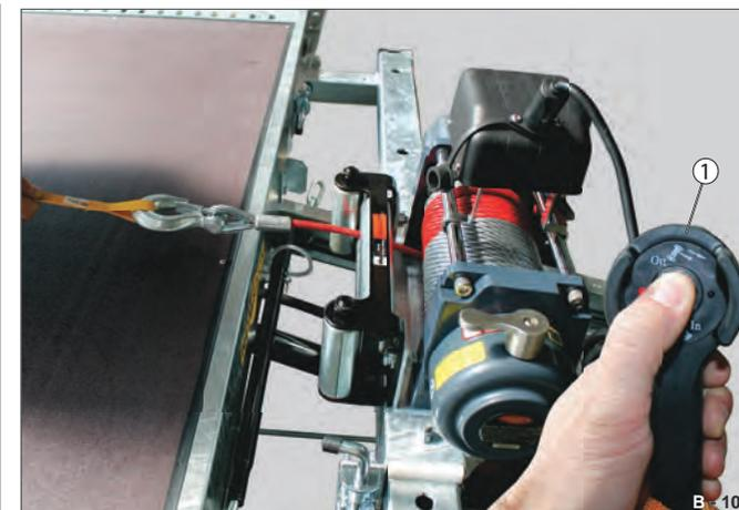
Fig. 45 Esempio 2: verricello con telecomando
