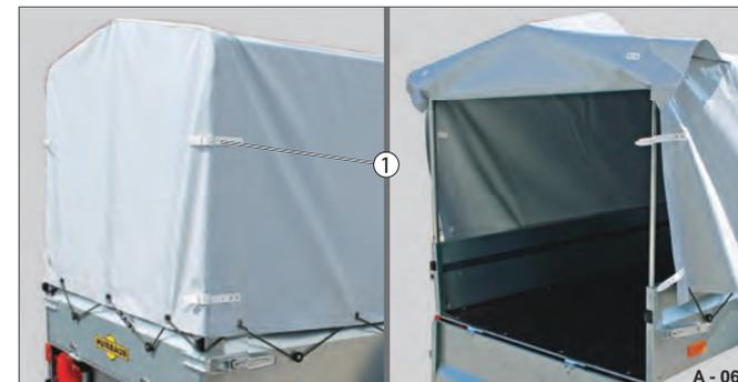
Fig. 71 Fibbia fissata / non fissata
