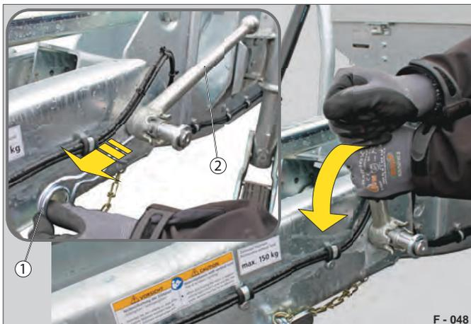
**Fig. 46** Sblocco della leva di bloccaggio
