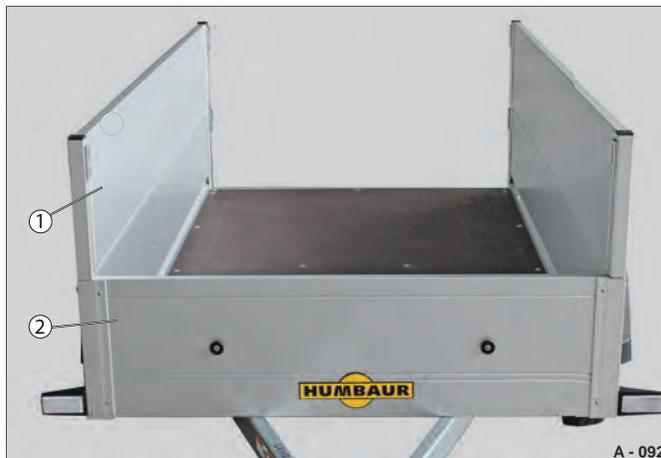
Fig. 26 Sponda posteriore / rialzo sponda smontato
