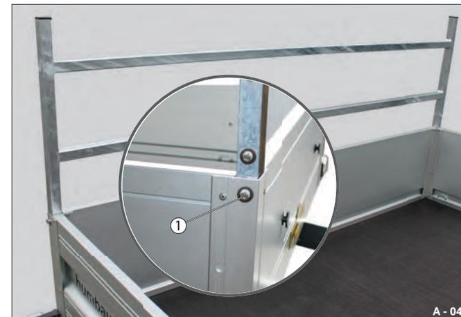
Fig. 33 Fissaggio sul telaio a H
