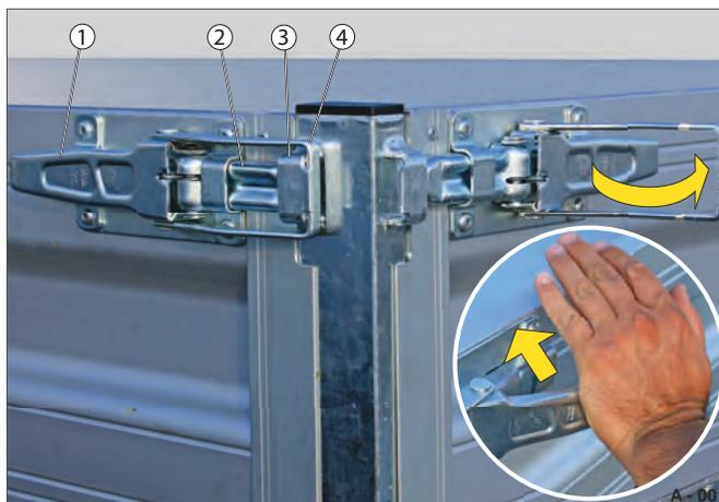
**Fig. 6** Chiusura a pressione (HU, HUK, HT, HTK)
