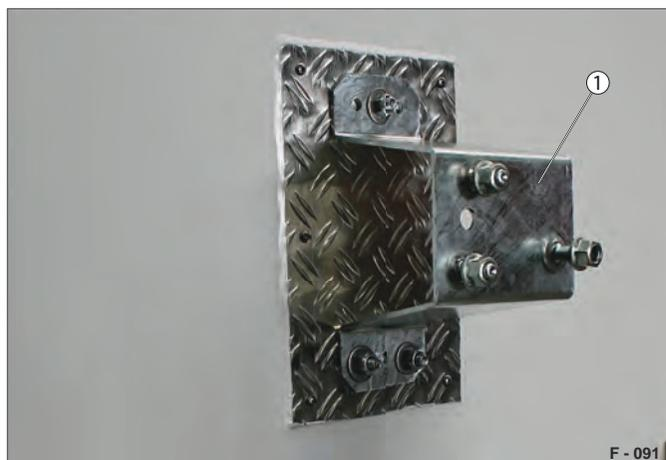
Fig. 85 Supporto ruota di scorta montato
