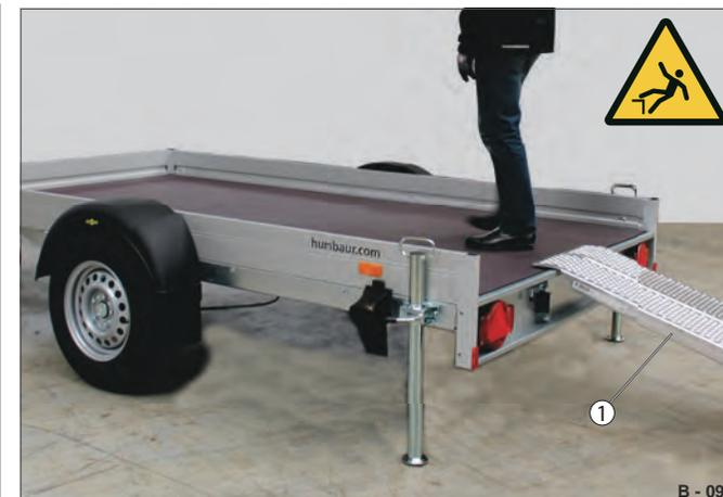
Fig. 30 Accesso al pianale di carico tramite appositi ausili
