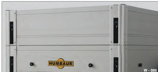
Fig. 87 Alluminio anodizzato
