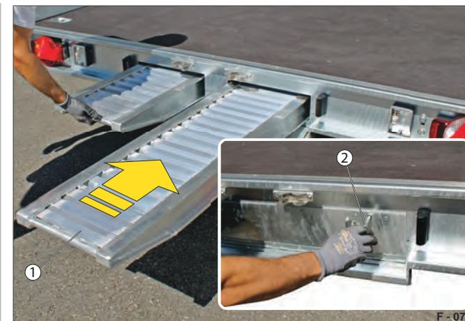
**Fig. 76** Esempio: HT, tavole di carico fissate
