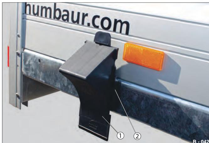
Fig. 76 Esempio 1: Cunei verticali laterali
