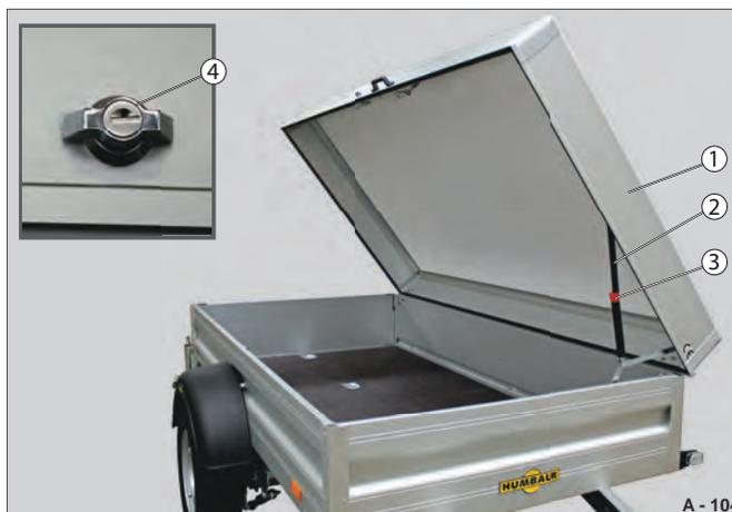
Fig. 93 Coperchio fissato lateralmente
