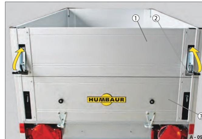
Fig. 27 Montaggio del rialzo sponda posteriore / anteriore
