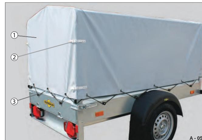
Fig. 63 Fissaggio fibbia / corda elastica
