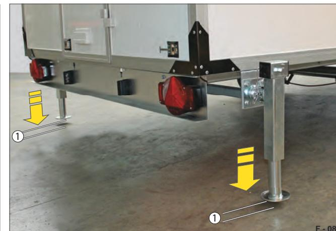
Fig. 20 Sostegno per le operazioni di carico
