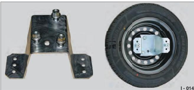
**Fig. 32** Supporto per ruota di scorta con/senza ruota di scorta
