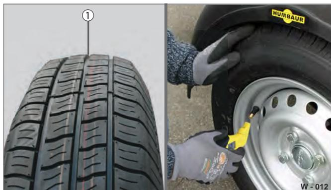
Fig. 14 Controllo della pressione di gonfiaggio
