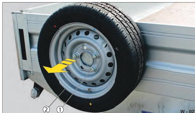
Fig. 28 Prelevare la ruota di scorta
