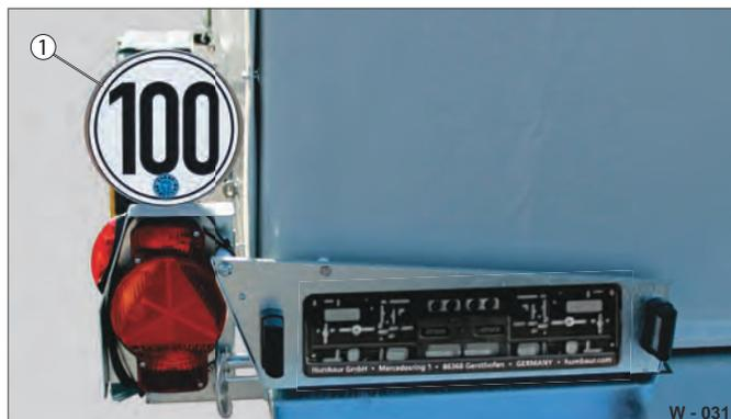
Fig. 33 Adesivo ufficiale per velocità 100 km/h
