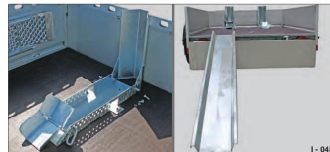
Fig. 55 Cavalletto per motocicli / rampa di carico per motocicli
