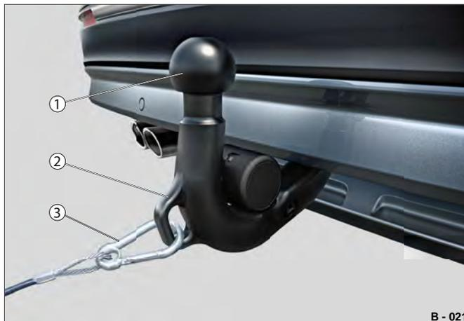
**Fig. 21** Esempio: cavo a strappo con moschettone fissato
