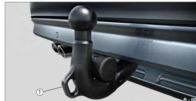
**Fig. 1** Esempio 1 (gancio fisso con occhiello anteriore)
