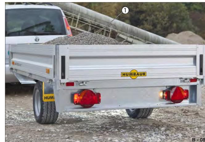
Fig. 66 Esempio: Fissaggio di un carico costituito da materiale sfuso
