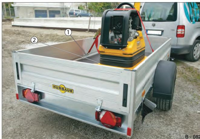
Fig. 65 Esempio: fissaggio di un carico solido
