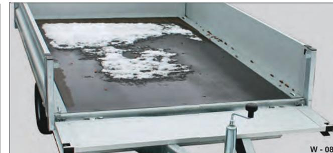
Fig. 89 Pianale di carico in legno / pannello in legno multistrato
