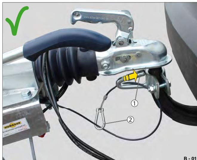
Fig. 18 Cavo a strappo fissato
