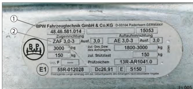
Fig. 21 Esempio: Adesivo dispositivo di comando a inerzia
