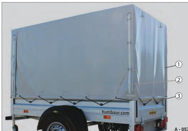
Fig. 62 Fissaggio con cinghia / corda elastica
