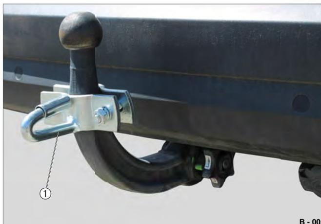
**Fig. 5** Esempio: Dispositivo di fissaggio nel gancio
