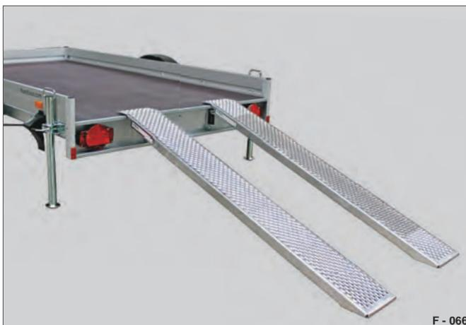
**Fig. 69** Esempio 3: Rampe di sollevamento (acciaio)
