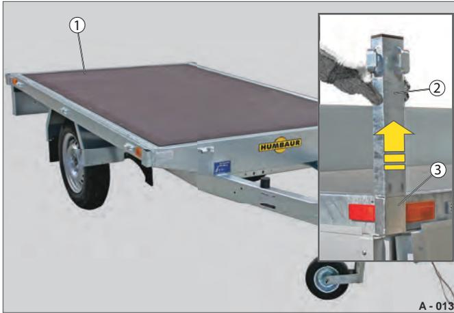
Fig. 14 Sponde smontate, montanti angolari sfilati
