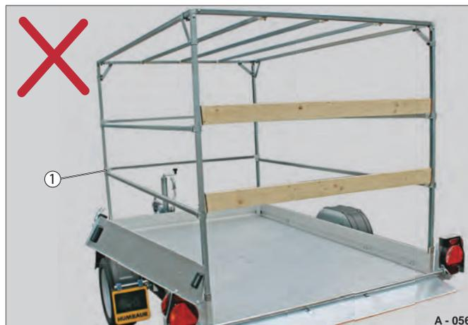
Fig. 65 Struttura a centina senza telone
