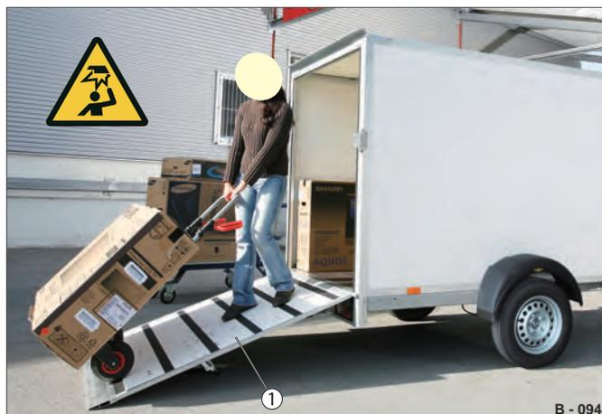
Fig. 34 Uso della sponda di carico
