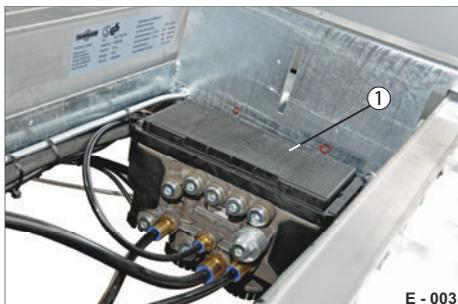
**Fig. 1** Brake module, programmable
