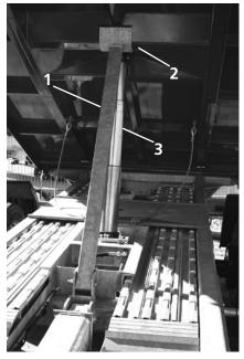
Point de graissage sur le vérin hydraulique
