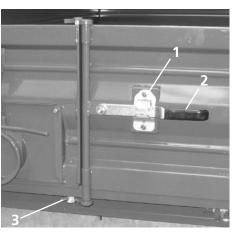
Portes battantes - dispositif de verrouillage
