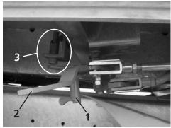
Dispositif de déverrouillage semi-automatique - position en mode oscillation
