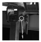
Béquille rabattable - raccord de graissage
