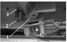
Dispositif de déverrouillage semi-automatique - dispositif de blocage
