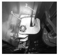
Dispositif de sécurité de la rampe enclenché
