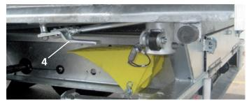
Levier de commande de la fonction d'oscillation (à l'arrière de la remorque, à gauche dans le sens de la marche)
