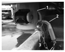
Palier oscillant avec boulon d'arrêt
