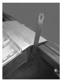
Dispositif de sécurité de la rampe ouvert et posé à l'arrière du véhicule.
