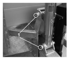
Barre de traction - raccord de graissage
