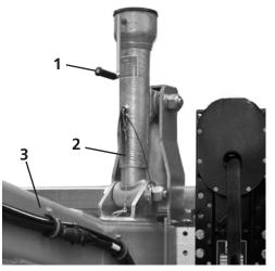
Dispositif de réglage en hauteur de la barre de traction
