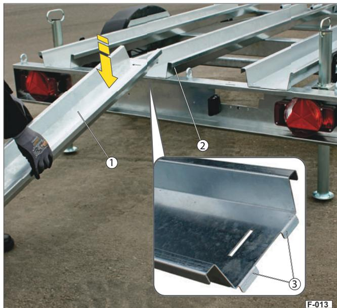
Abb. 13 Auffahrschiene positionieren
