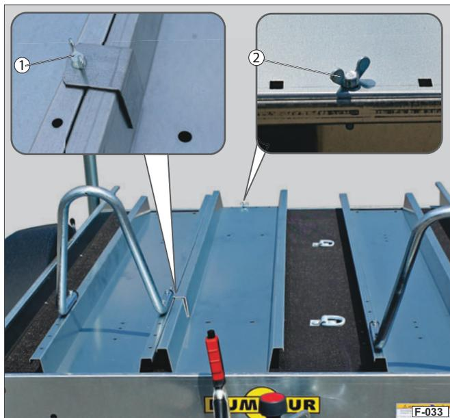
Abb. 26 Auffahrschiene gesichert (Fahrstellung)
