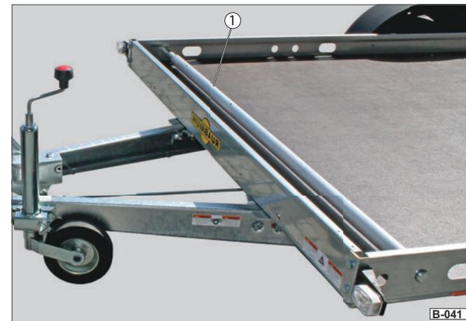
Abb. 47 Radstopper positioniert
