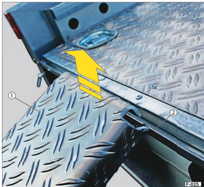
**Abb. 33** Auffahrschiene ausgehängt
