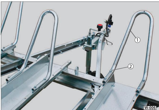
**Abb. 6** Standbügel kontrollieren
