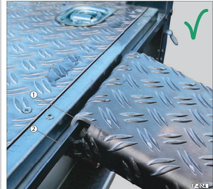
**Abb. 32** Auffahrschiene gesichert
