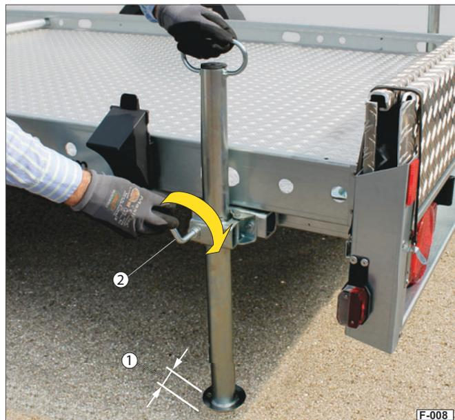
Abb. 8 Schiebestütze fixieren
